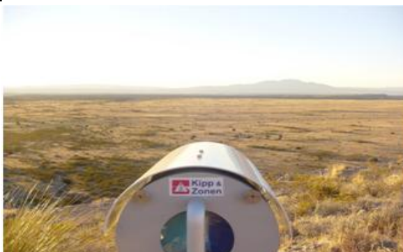
Figura 1. Scintilómetro instalado en New México por los Dr Hendrick y Kleissl. Los scintilómetros se utilizarán para la aprobación, calibración, y desarrollo de parámetros de los algoritmos con información de sensores remotos. Las dimensiones de Scintillómetro en los trópicos húmedos nos permiten (i) entender bien el efecto de balanzas espaciales en los flujos de calor sensatos y latentes, (ii) para validar y (iii)
