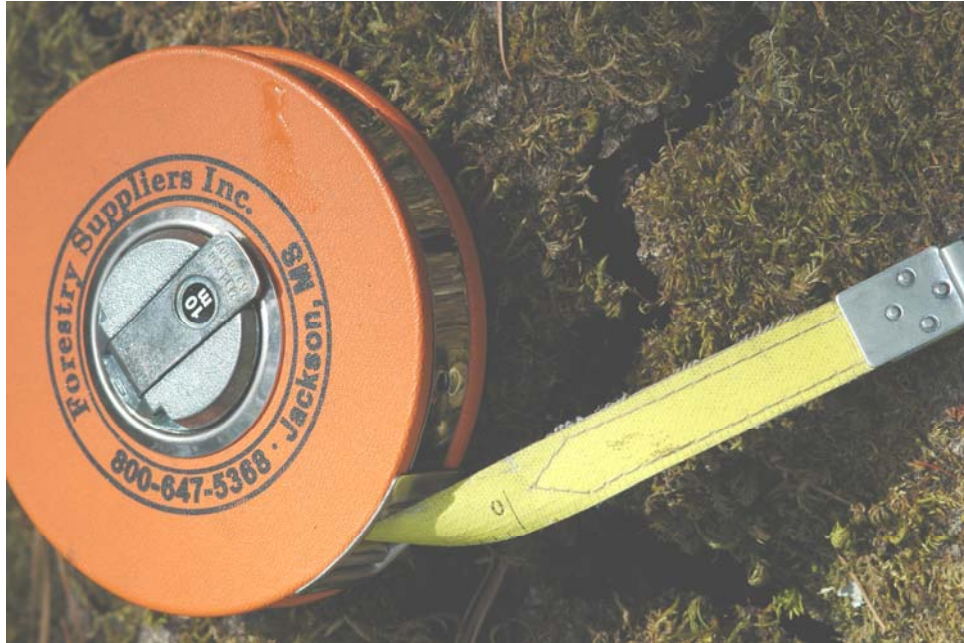
Cinta para medir diámetros, tiene una escala lineal y otra con su equivalente al diámetro
