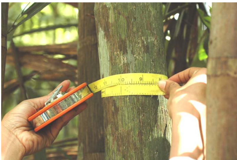
Figura No.3. Se muestra la forma en que se utiliza la cinta diamétrica para medir los DAP de los árboles mayores o iguales a 10cm,
