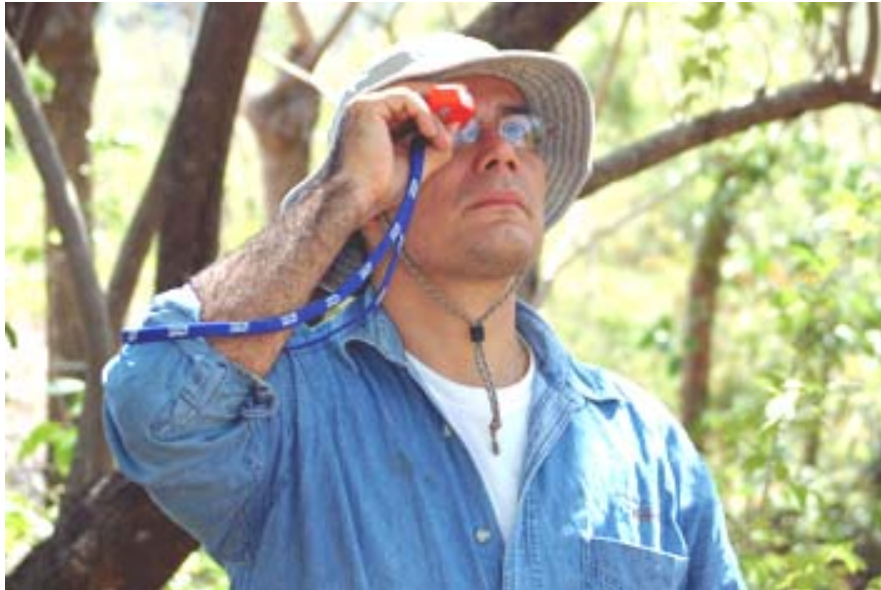
Figura No.6. Se muestra el uso del clinómetro electrónico modelo Haglöf (HEC-MD) utilizado para medir las alturas de los árboles dentro de la parcela.
